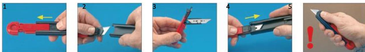
Spingere indietro la parte interna in plastica premendo sul cursore della lama (fig. 1)
